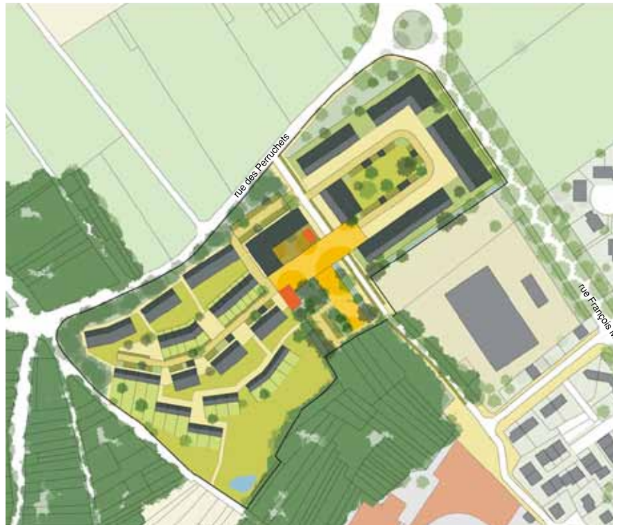
plan masse - une alternance de bandes construites, orientées vers le soleil et parallèles au relief et d'espaces libres dévolus à la rétention des eaux pluviales et à la biodiversité
