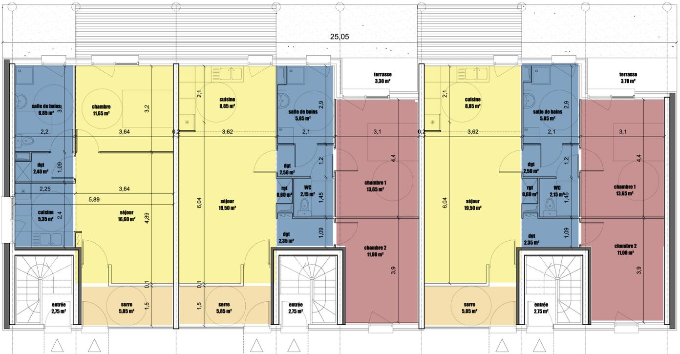
bâtiment C, individuels superposés: logements traversants avec capteurs solaires et serres froides
