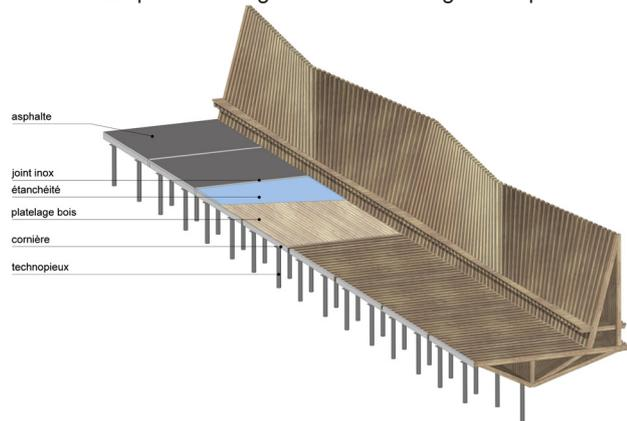
Schéma axonométrique de la structure de la passerelle
